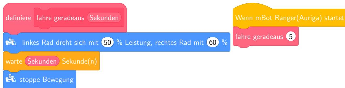
Erstellt einen eigenen Block „fahre geradeaus“ mit dem Parameter „Sekunden“ wie oben abgebildet. Verwendet die Werte aus Aufgabe 3, damit der Roboter auch wirklich geradeaus fährt.
